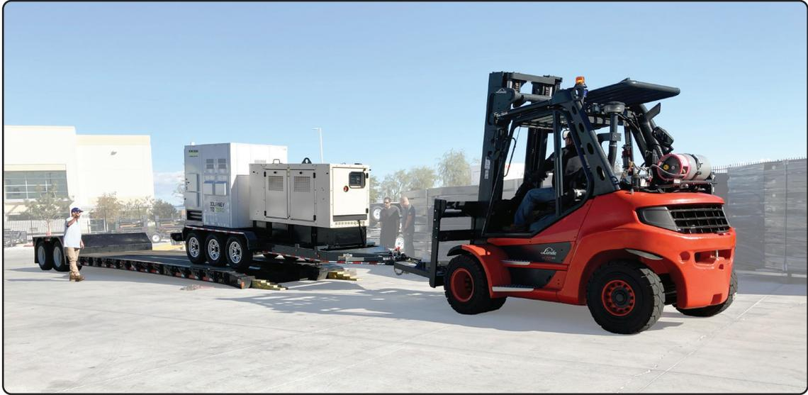
4) Éloignez complètement l'EBOSS™ de la remorque à plateau. Mettez les crics de la remorque en position verticale et abaissez les fourches pour poser l'EBOSS™ sur le sol. Débranchez l'attelage pivotant.
