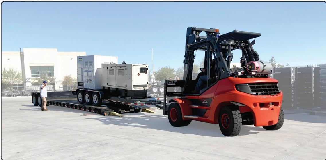
**4)** Abaissez délicatement les fourches et positionnez l'EBOSS™ sur la remorque à plateau. Débranchez l'attelage pivotant et éloignez lentement le chariot de fourches de la remorque. Fixez le matériel nécessaire pour sécuriser la charge.
