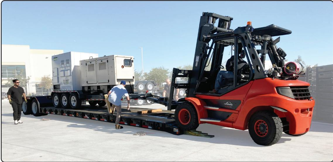
**2)** Positionnez l'attelage pivotant (Pintle) pour le connecter à la remorque EBOSS™. Soulevez lentement les fourches pour mettre l'EBOSS™ à niveau. Commencez à reculer prudemment l'EBOSS™ hors de la remorque à plateau.
