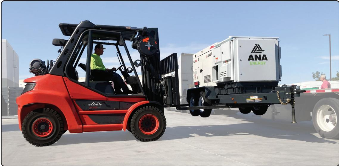
4) Abaissez lentement les fourches en plaçant l'EBOSS™ au sol. Abaissez les fourches de quelques centimètres supplémentaires pour qu'elles dégagent complètement l'EBOSS™. Éloignez soigneusement le chariot élévateur de l'EBOSS™.
