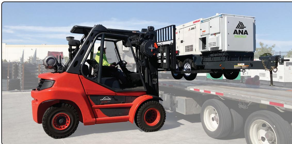
4) Abaissez soigneusement l'EBOSS™ sur la remorque à plateau. Abaissez lentement les fourches pour vous assurer que la charge est stable sur la remorque. Une fois que les fourches sont dégagées de l'EBOSS™, éloignez lentement le chariot élévateur de la remorque.
