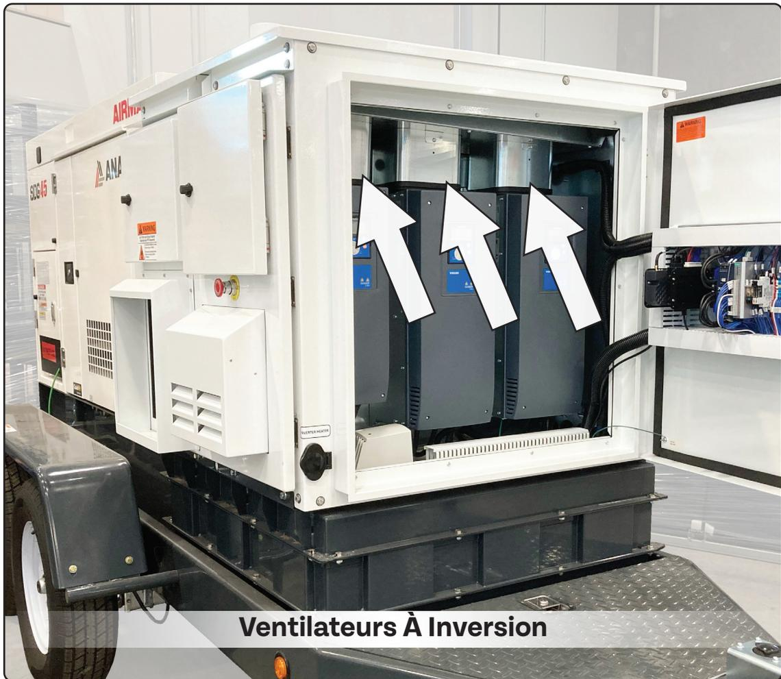
De l'air comprimé doit être utilisé pour éliminer la poussière et les débris des ventilateurs. N'entrez pas en contact entre les buses des canettes et l'électronique interne sensible de l'EBOSS™, car des dommages pourraient en résulter.
