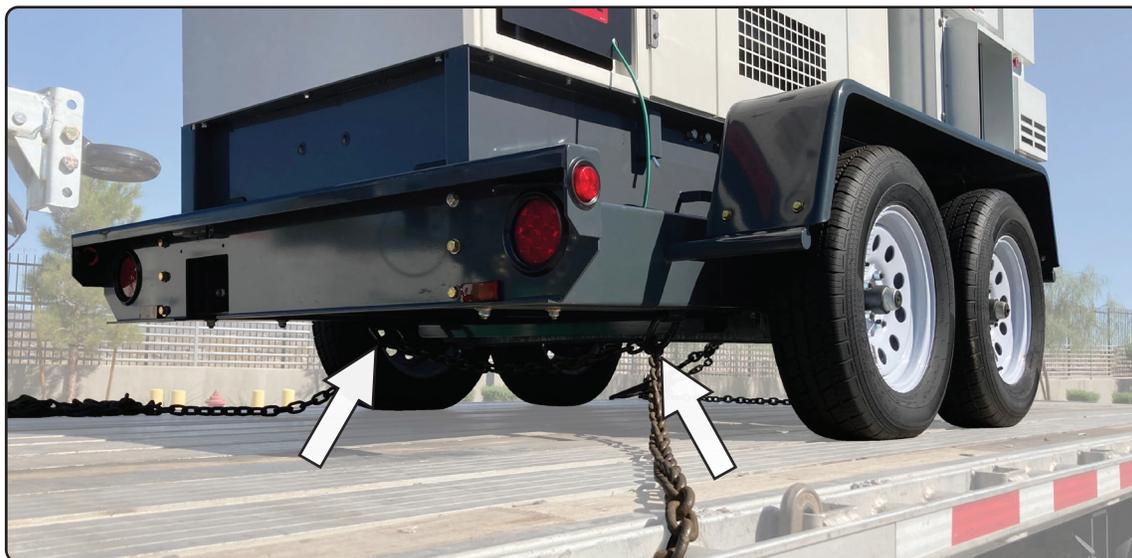
Les emplacements d'arrimage sont situés devant les essieux avant (2) et derrière les essieux arrière (2). Ceux-ci sont conçus uniquement pour attacher et ne sont pas conçus pour soulever l'EBOSS™.
