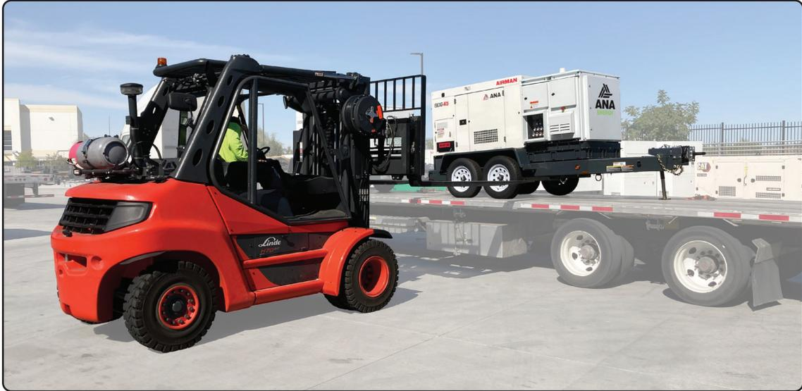
2) Placez les fourches à soulever derrière l'essieu arrière et devant l'essieu avant pour équilibrer la charge. Soulevez lentement les fourches jusqu'à ce qu'elles entrent en contact avec l'EBOSS™. Soulevez délicatement l'EBOSS™ de la remorque.
