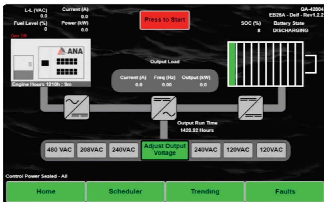
La partie supérieure gauche de l'écran, au-dessus du générateur, affiche la tension de ligne (VAC), le courant (A), le niveau de carburant (%) et l'alimentation (KW) du générateur. Lorsque l'on appuie sur le bouton de démarrage, l'état du générateur affiche ce qui suit :
