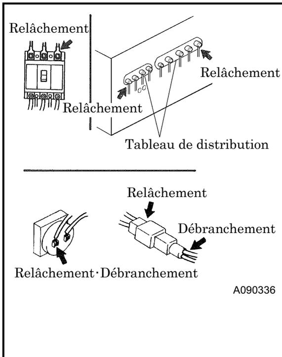
Vérifiez s'il y a du jeu sur les câbles, des dommages sur les gaines isolantes, des débranchements, des câbles déconnectés ou des courts-circuits, etc.
